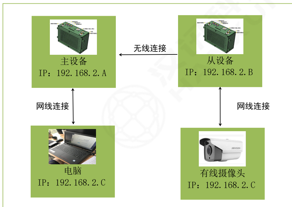
图 2 点对点组网模式示意图
